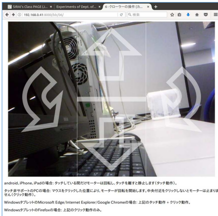
図 3.3 ウェブブラウザに映し出された画面。矢印をクリックするとロボットが動く
